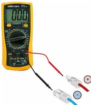
4. Verifique a polaridade positiva e negativa das strings e conecte os conectores fotovoltaicos aos terminais certos. Pode ocorrer danos graves ao inversor e conector com o superaquecimento.
